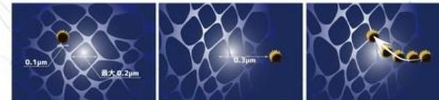
空気中の微粒子が  $0.1 \mu\text{m}$  なのに対し、ナノファイバーフィルターの隙間は最大で  $0.2 \mu\text{m}$  ありますが、微粒子がナノファイバーフィルターの  $0.3 \mu\text{m}$  まで近づくとファンデルワールス力が働き、微粒子をナノファイバーフィルターに引き寄せ、吸着させます。
