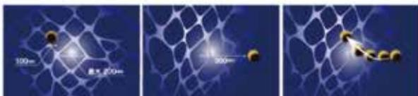
空気中の微粒子が100nmなのに対し、ナノファイバーフィルターの隙間は最大で200nmありますが、
